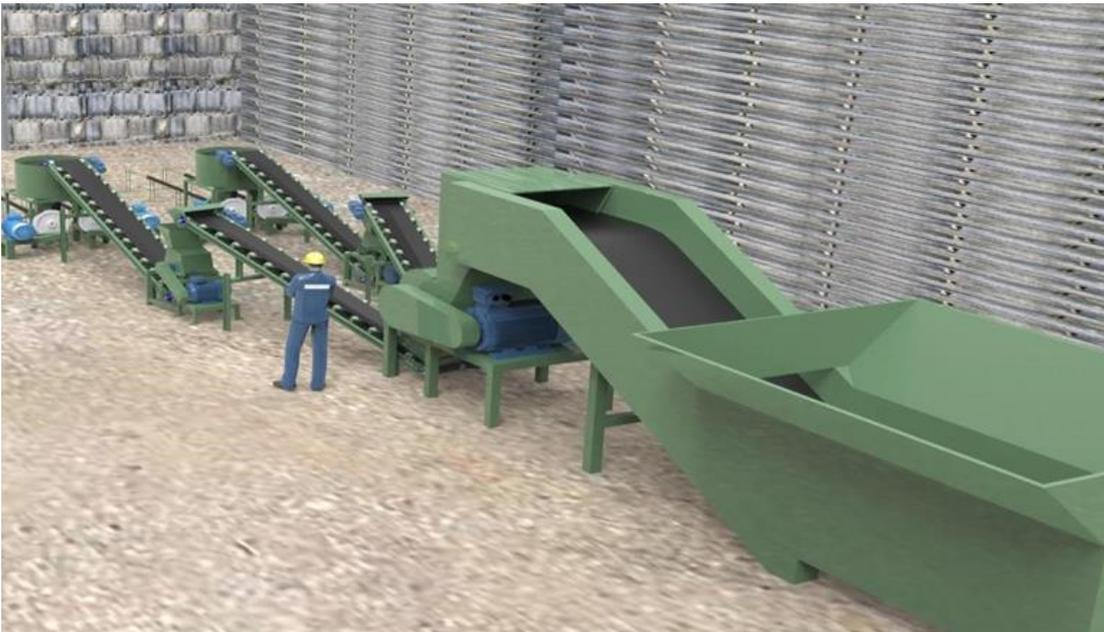
**3. Beispiel einer angeordneten Briкетtlinie mit zwei Auswürfen**
